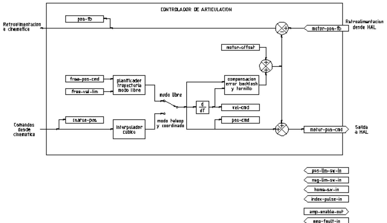
**Diagrama de bloque del controlador articular** La figura anterior muestra cinco de los siete conjuntos de información de posición que forman el flujo principal de datos a través del controlador de movimiento. Las siete formas de datos de posición son las siguientes:
